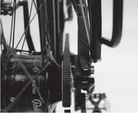
Afbeelding 3: correcte uitlijning van de riem
