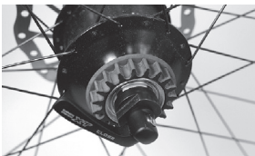
Afbeelding 2: borgen van de Rohloff tandkransafnemer met snelspanner of asmoer
