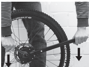
Afbeelding 5: vastzetten van de achterste tandriemschijf met de tandriemschijfsleutel en een steeksleutel M24 voor het tegenhouden van de Rohloff tandkransafnemer
