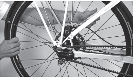
Afbeelding 3: correcte uitlijning van de riem
