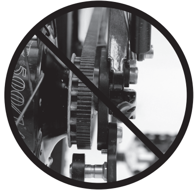
Afbeelding 4: onjuiste uitlijning van de riem
